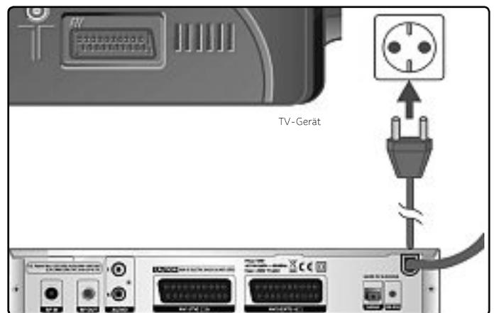
**Nachdem** Sie alle Verbindungen hergestellt haben, können Sie das Gerät mittels Netzadapter an eine Steckdose anschließen.
