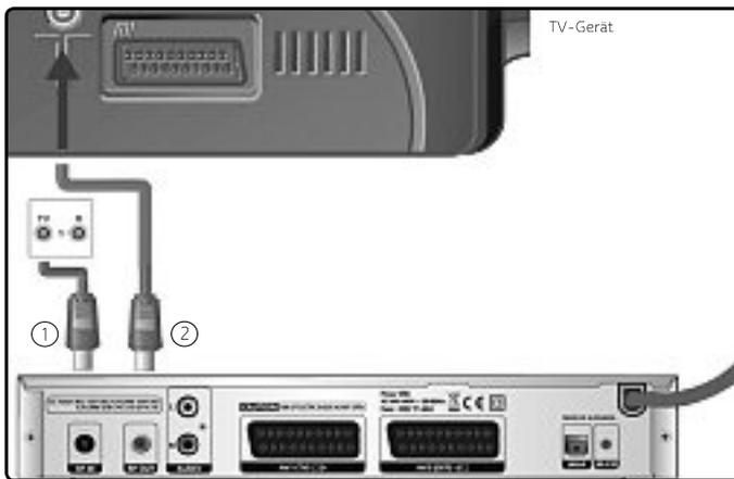
Verbinden Sie die Kabeldose und die Antenneneingangsbuchse (RF IN) des Digital-Receiver. Nutzen Sie hierfür bitte das **mitgelieferte Antennenkabel** (Koaxial-Kabel) ①. Anschließend verbinden Sie bitte mit Ihrem **vorhandenen Antennenkabel** (Koaxial-Kabel) die Antennenausgangsbuchse (RF OUT) des Receivers mit Ihrem TV-Gerät ②.
