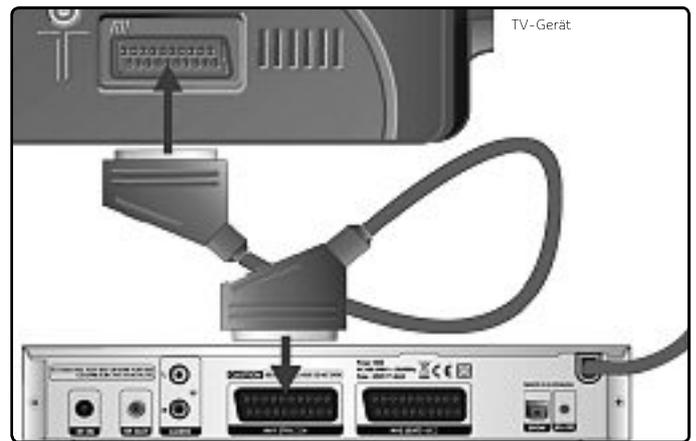
Anschließend verbinden Sie Digital-Receiver (Ausgang AV1/ TV) und Fernsehgerät mit einem SCART-Kabel.
